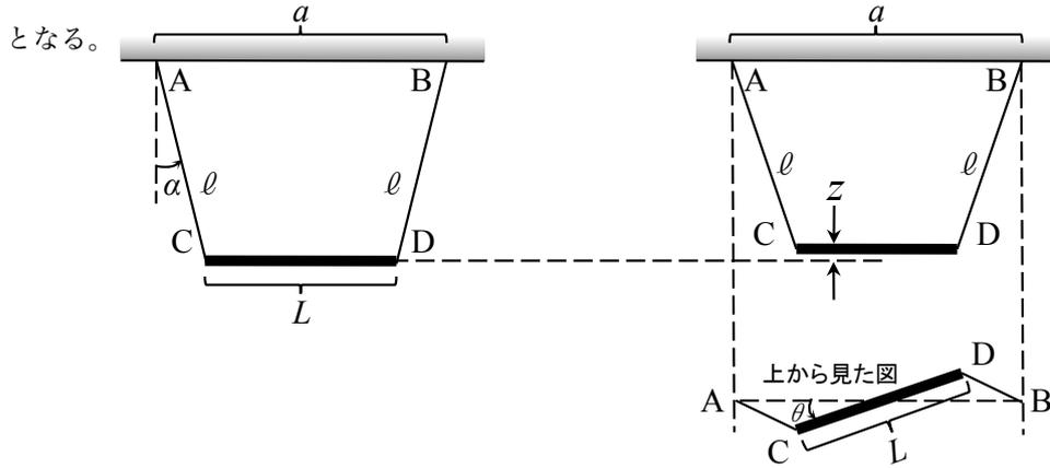
図 2.8: 棒振り子。左：安定静止位置の正面図。右：水平に $\theta$ 捻った場合の正面図および上から見た図。
